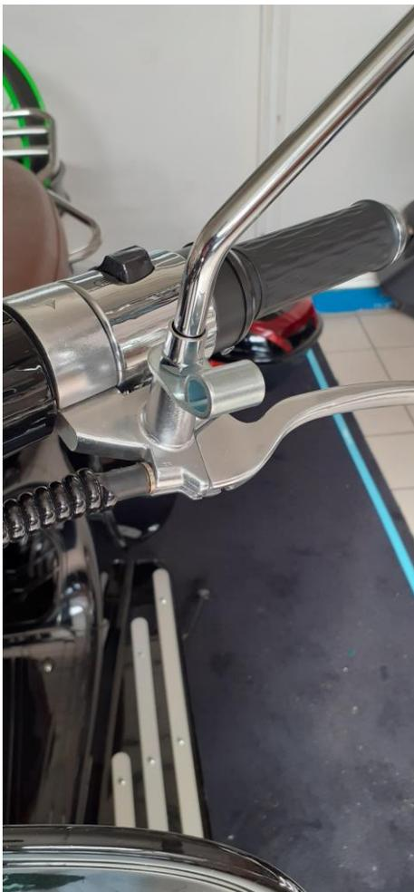
**Installer les supports sous les rétroviseurs**
