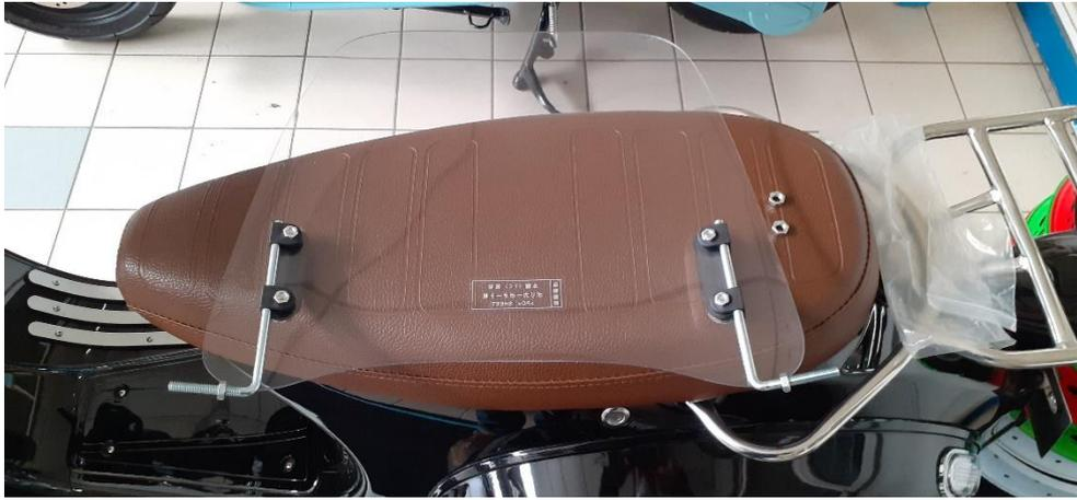
**Positionner les deux tiges chromées sur le pare-brise coté interne et boulonner**
