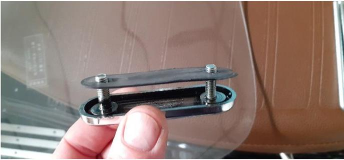
Mettre les caoutchoucs sur les fixations chromés et les positionner sur le pare-brise coté externe
