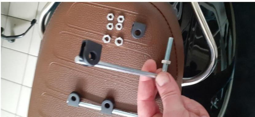
Installer les fixations plastiques sur les tiges chromées ainsi qu'un écrou
